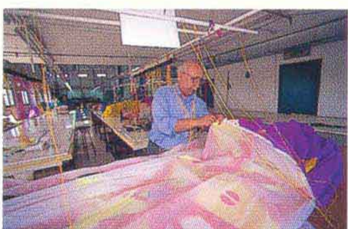
ラインの取り付け。アブコはストラップを使わず、ダイレクトにつけて滑らかにし、抗力を減らす手法を続けている。
