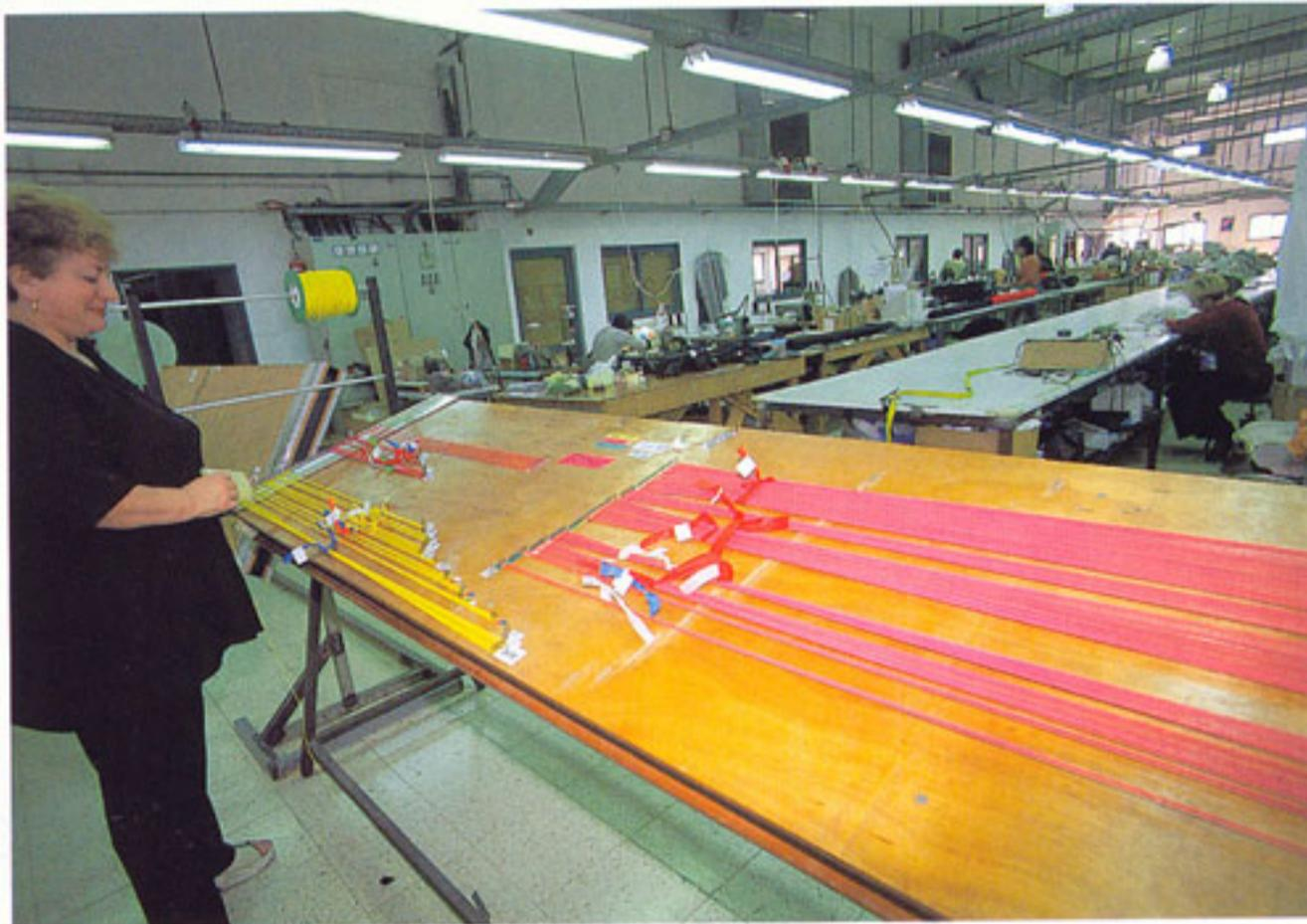
Table de contrôle des suspentages avant le montage sur les ailes
