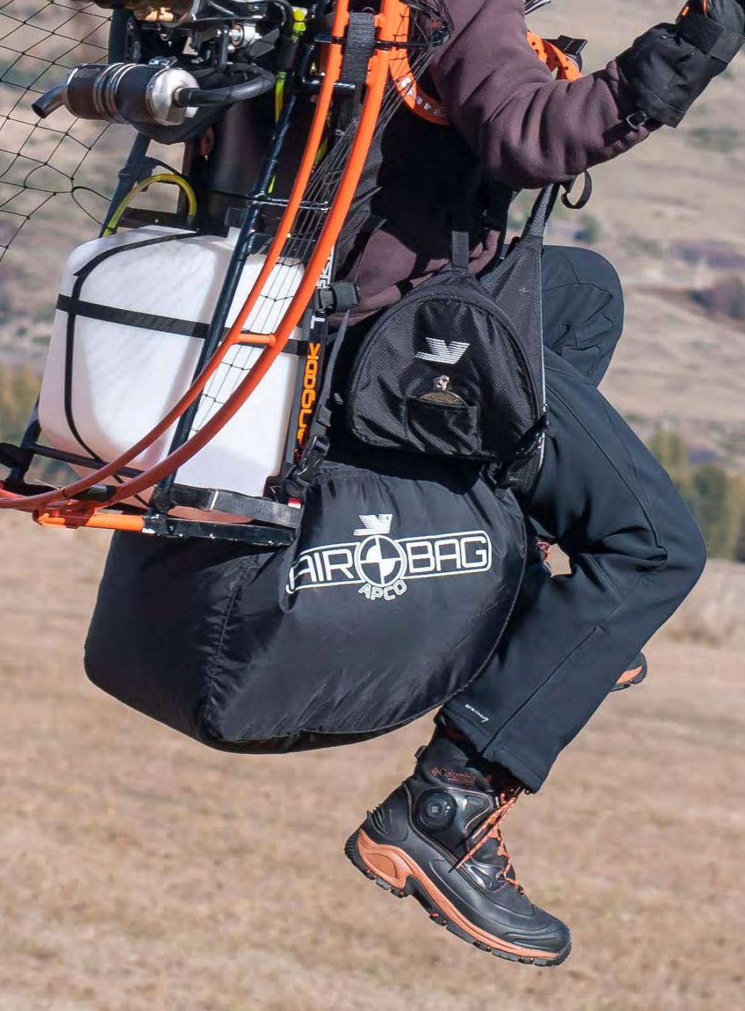
Diese optionale Seitentasche zum Splitleg-Gurtzeug ist sogar mit einem Spiegel zur Tankfüllungs-Prüfung versehen (in der kleinen Tasche unterhalb des Apco-Logos). Er kann herausgezogen werden und bleibt dank einer automatischen Fadenrolle immer mit dem Sitz verbunden.
